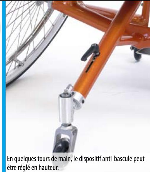
En quelques tours de main, le dispositif anti-bascule peut être réglé en hauteur.
