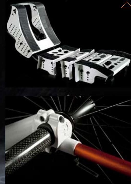
Grâce à ses pièces forgées, la fixation de l'axe est très rigide et son poids ultra réduit. L'axe complet est disponible en aluminium ou en carbone.
