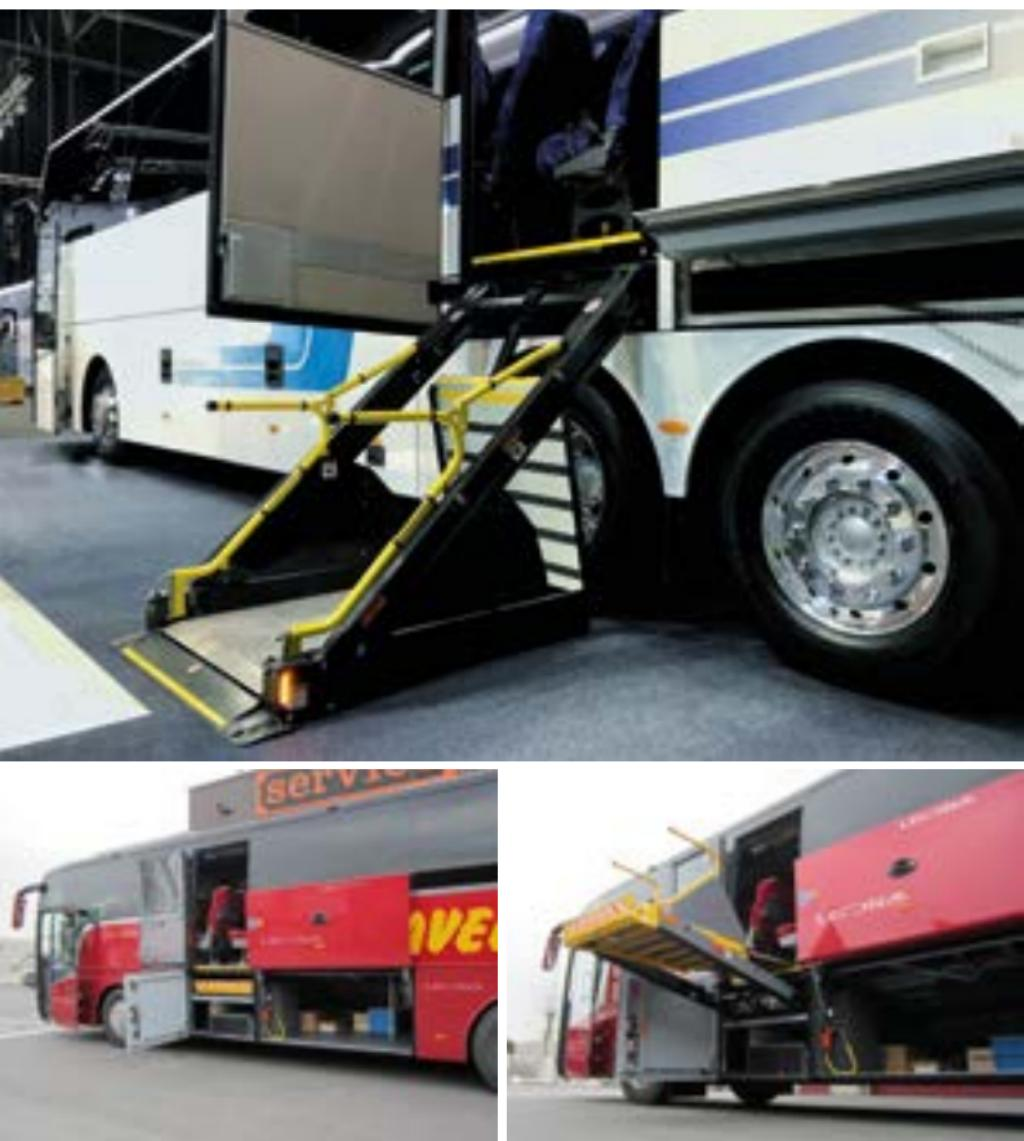
Les **DH-CH101.03 et .05** sont conçus pour un montage sur bus M3 et cars, dans un **compartiment situé bien au dessus du sol** (au dessus de l'essieu arrière).
