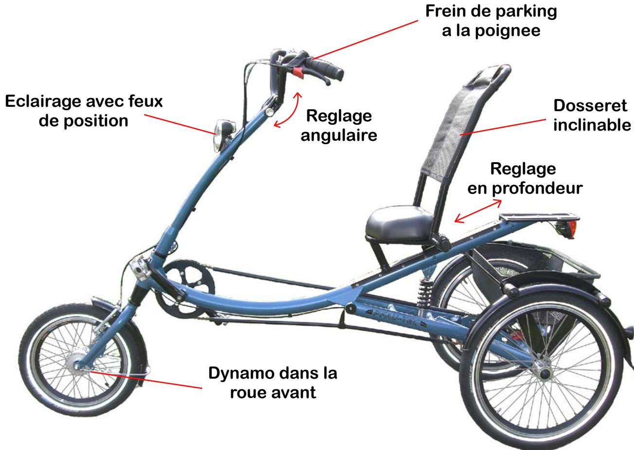
► Le ScooterTrike est un tricycle allongé réunissant stabilité et maniabilité. Son système d'amortisseur couplé au cadre articulé offre confort et souplesse dans la conduite. Son assise large et son dossier réglable assurent une position de conduite agréable à son utilisateur. Il se décline dans différentes versions avec au choix :
