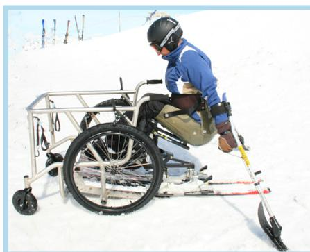
▲ Avec Snowwheel, tout skieur assis utilisant un appareil de ski pour paraplégiques, peut atteindre les télécabines sans avoir à sortir de son appareil et à se transférer sur un fauteuil roulant. Le Snowwheel est aujourd'hui plébiscité par les utilisateurs pour l'autonomie procurée, il est en phase avec le développement du ski assis.
