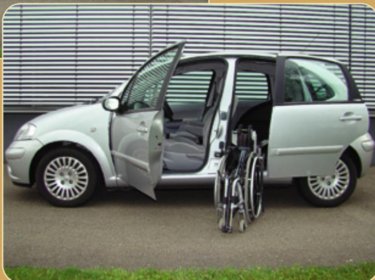
LA PORTE ARRIÈRE COULISSANTE ET SON ROBOT CHARGEUR PERMETTENT DE CHARGER AUTOMATIQUEMENT UN FAUTEUIL ROULANT DERRIÈRE LE SIÈGE CONDUCTEUR, TOUT EN PRÉSERVANT UNE PARTIE DE LA BANQUETTE ARRIÈRE.
