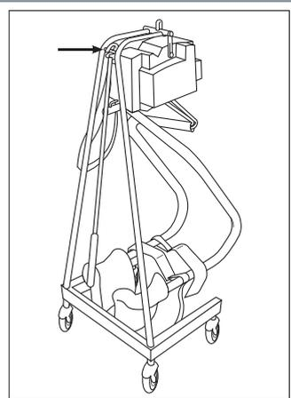
enlever la barre de décrochage. Suspendez la barre de décrochage au chariot de transport et faites le rouler jusqu'à une autre pièce.
