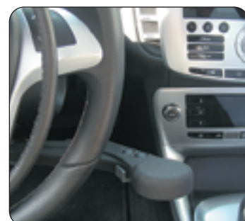
Frein avec cliquetage de positionnement.
