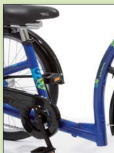
Le cadre extra bas et large permet un transfert autonome
