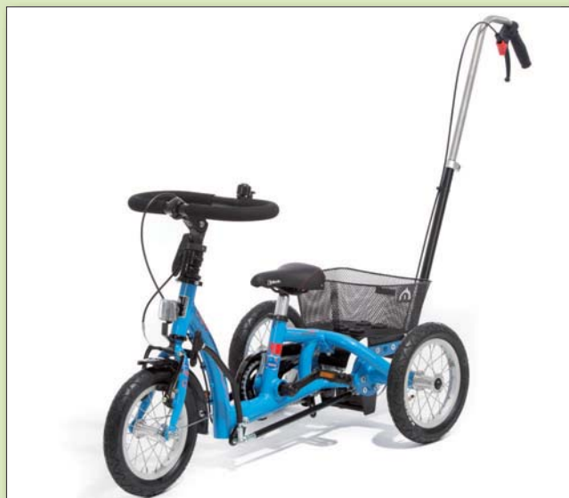
Barre de poussée et contrôle de direction pour personne accompagnante
