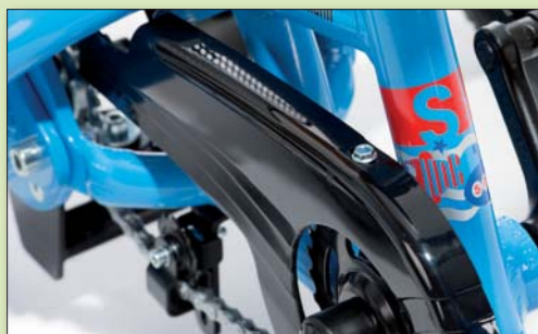
Guide-chaîne de haute qualité pour un fonctionnement doux et silencieux
