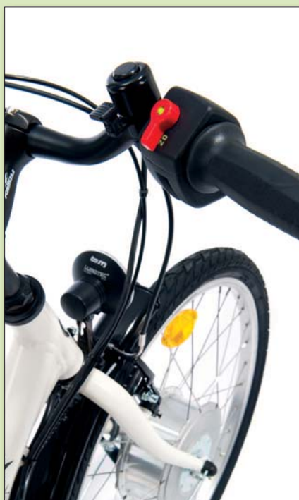
Commande par poignée rotative avec fonction On/Off
