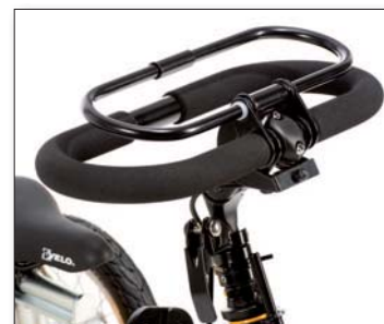
Guidon circulaire avec poignée de frein
