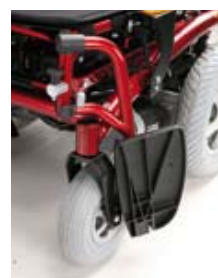
Les repose-pieds sont escamotables et amovibles
