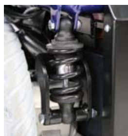
Space est équipé d'amortisseurs sur les roues arrières
