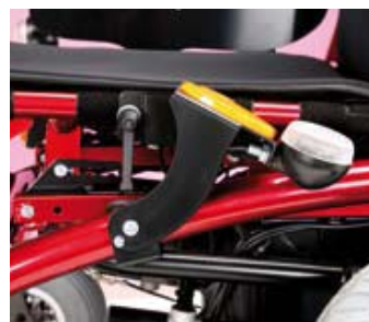
Les feux avant sont escamotables pour faciliter les déplacements dans les lieux étroits.
