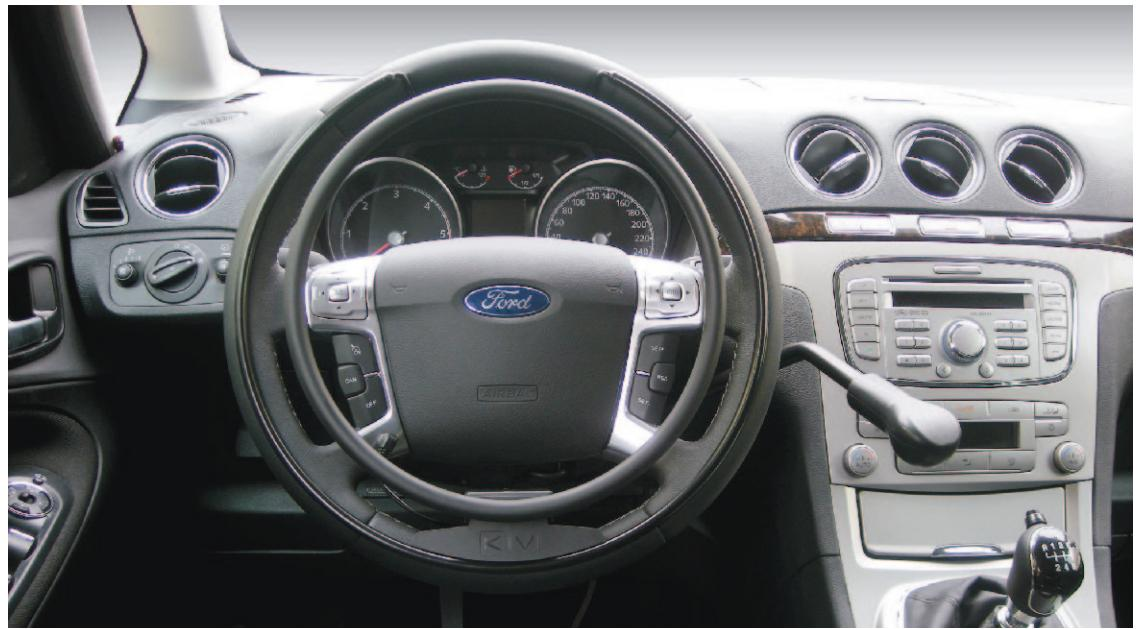
**Le cercle sur volant Kivi, représente une nouvelle génération d' accélérateur, il est complètement démontable de son siège.**
