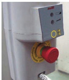
Boîtier électronique équipé de l'arrêt d'urgence et indicateurs d'alarme
