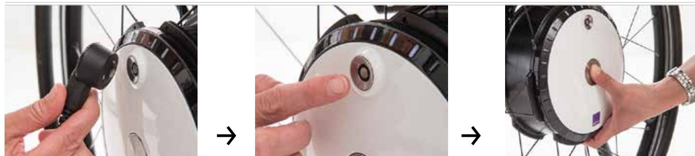
Le connecteur de charge est situé sur la roue...
