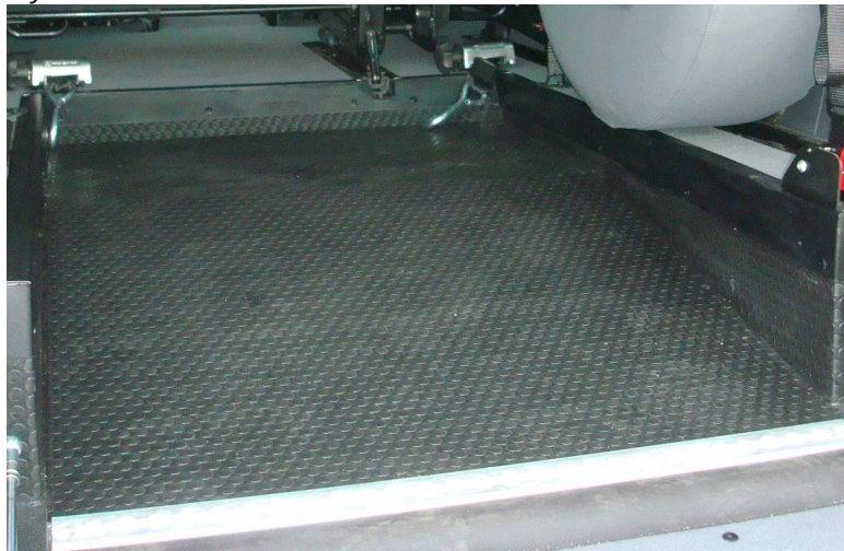
Décaissement ergonomique (sans ressaut)
