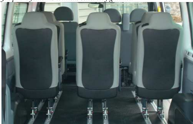
Rails commun pour les sièges amovibles et les fauteuils roulants permettant une grande convertibilité
