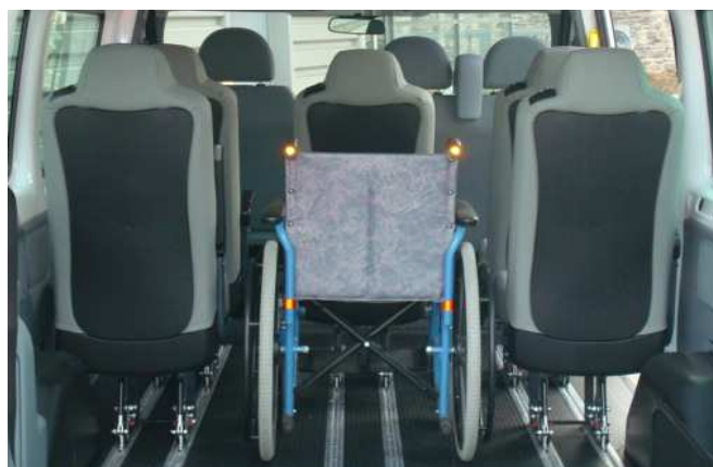
Rails commun pour les sièges amovibles et les fauteuils roulants permettant une grande convertibilité
