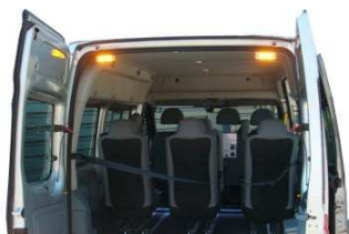
Rappel de feux de détresse
