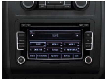
La radio " RCD 510 ". Elle intègre toutes les fonctions du " RCD 310 ". Elle dispose également d'un chargeur six CD intégré, d'un lecteur de cartes SD et d'un large écran tactile.
