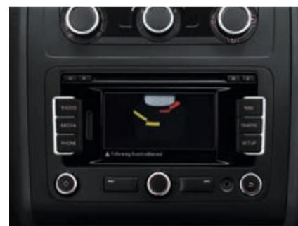
**L'aide au stationnement arrière.** Un signal sonore indique au conducteur la distance par rapport à l'obstacle lors des manœuvres de stationnement. De plus, l'écran de la radio ou du GPS donne une information visuelle.
