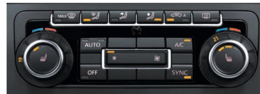
**La climatisation "Climatronic".** La climatisation automatique avec commande de température deux zones permet que celle-ci soit maintenue à un niveau constant. Des capteurs enregistrent les changements de température et ajustent automatiquement la ventilation et la température de l'air.
