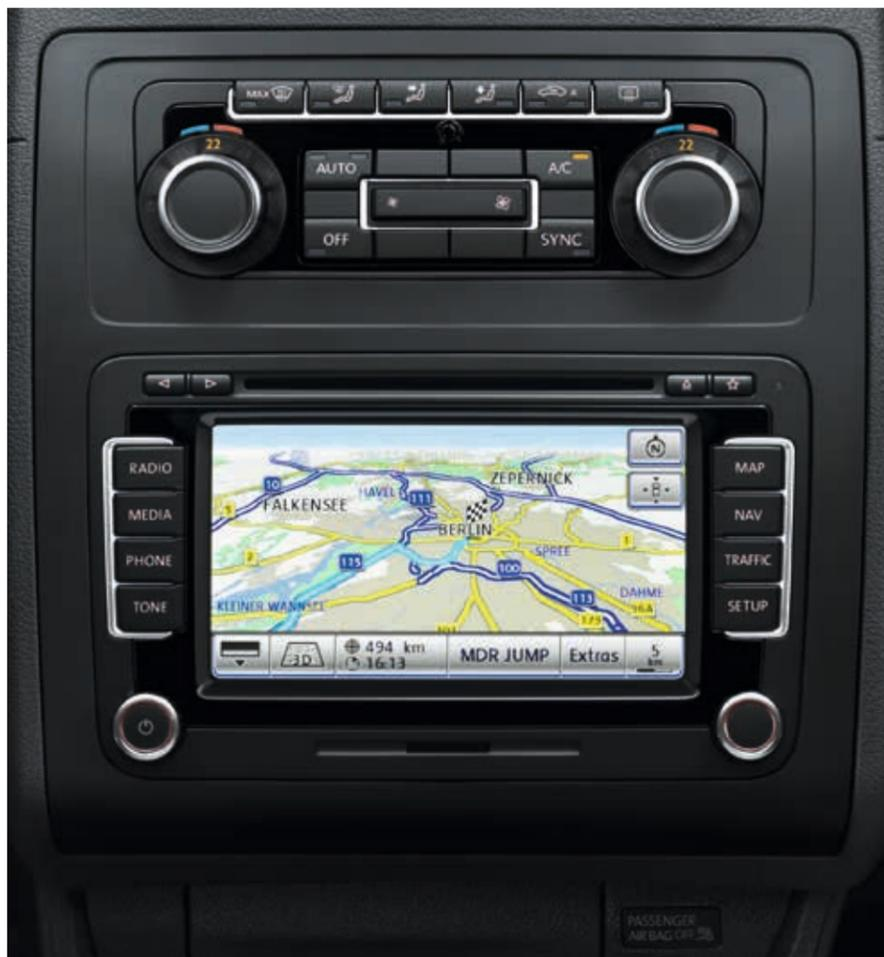
Le système de radionavigation " RNS 510 ". Ce système offre toutes les fonctions du " RNS 315 ", mais dispose d'un écran tactile couleurs 6,5". Le DVD fourni contient toutes les cartes d'Europe de l'Ouest. Il peut être copié sur le disque dur de 30 GO du " RNS 510 ", et vous pouvez écouter aussi vos CD préférés en même temps. En plus, le système peut être commandé vocalement, afin que vos mains restent sur le volant.
