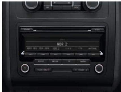
La radio " RCD 310 ". La radio " RCD 310 " dispose de toutes les fonctions de la " RCD 210 " plus une interface AUX-IN dans le compartiment de la boîte à gants ainsi qu'un écran plus large et, sur demande, la réception numérique (DAB+).
