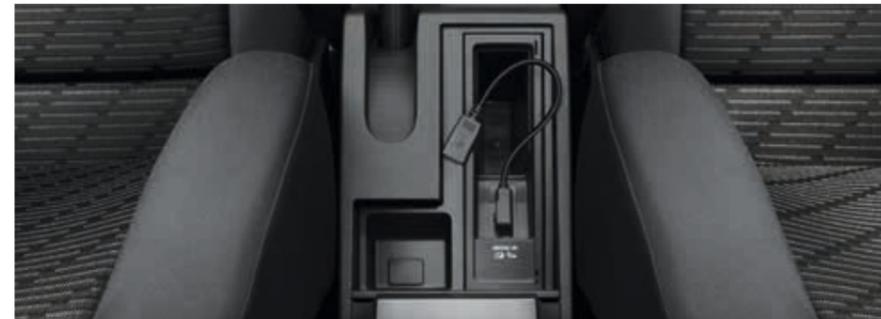
**L'interface MEDIA-IN.** Elle permet de raccorder des sources audio externes telles que clés USB ou lecteurs MP3 avec certification USB. Elle fonctionne via les radios " RCD 310 " et " RCD 510 ", ou les systèmes de radionavigation " RNS 315 " et " RNS 510 ". Avec un câble adaptateur supplémentaire, disponible en option, elle est également compatible avec un Apple iPod® ou iPhone® de quatrième génération et au-delà.
