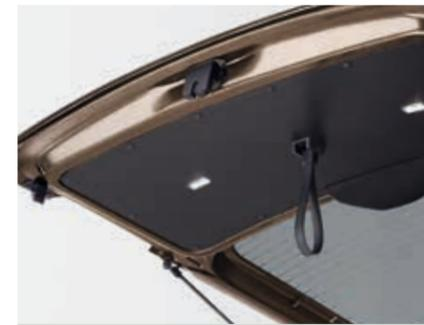
**L'éclairage de hayon.** Cet éclairage de hayon à LED assure une meilleure visibilité dans le coffre afin de faciliter le chargement et le déchargement.
