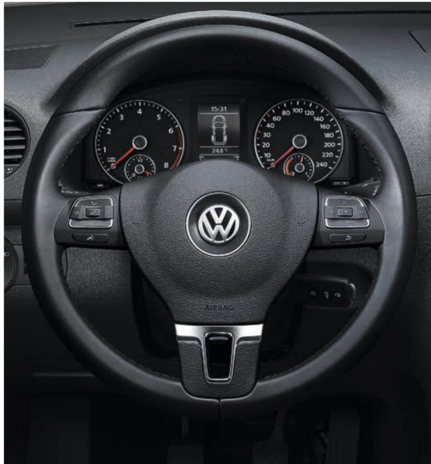
**Le volant multifonction.** Le volant trois branches, gainé de cuir, est doté d'un réglage en hauteur et profondeur. Les commandes intégrées permettent au conducteur de commander la radio, le GPS et le téléphone mobile.
