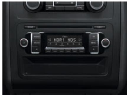
La radio " RCD 210 ". La radio dispose d'un affichage des stations RDS, d'un lecteur de CD compatible MP3, d'une interface pour connecter un téléphone mobile et d'une connexion AUX-IN.
