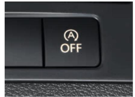
**Le système Start-Stop.** Pour une conduite économique. Par exemple, au feu rouge : vous êtes au point mort et le moteur s'arrête. Lorsque le feu passe au vert vous réembroyez et le moteur redémarre.
