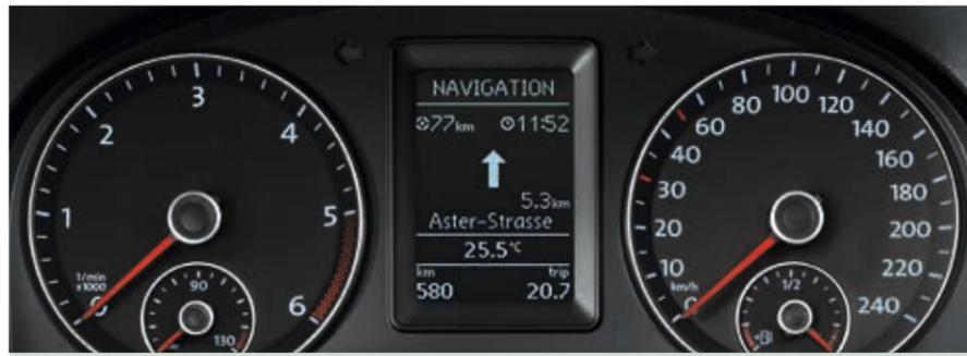
**L'ordinateur de bord Plus.** Outre les fonctions de la version de base, la version Plus permet de régler le chauffage additionnel à eau (option) et le pack Lumière-visibilité (option). De plus, il affiche en outre les flèches directionnelles associées au système de navigation en option et, avec la préparation téléphone (également en option), il vous permet de commander votre mobile.
