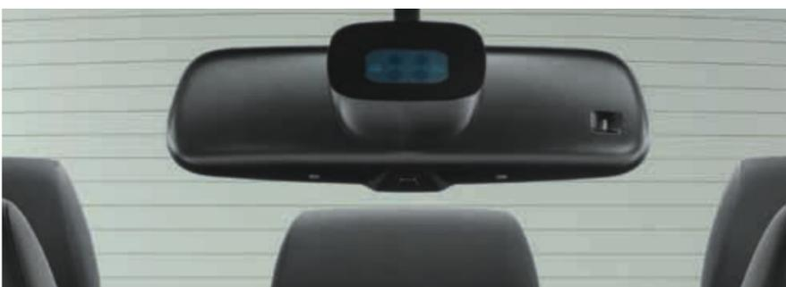
**Le pack Lumière-visibilité.** Le rétroviseur intérieur s'obscurcit automatiquement pour ne pas être ébloui par les phares du véhicule situé derrière vous. Un capteur placé dans le support du rétroviseur allume automatiquement les phares lorsqu'il fait sombre. Lorsqu'il commence à pleuvoir, il active les essuie-glaces et adapte leur vitesse à l'intensité de la pluie.
