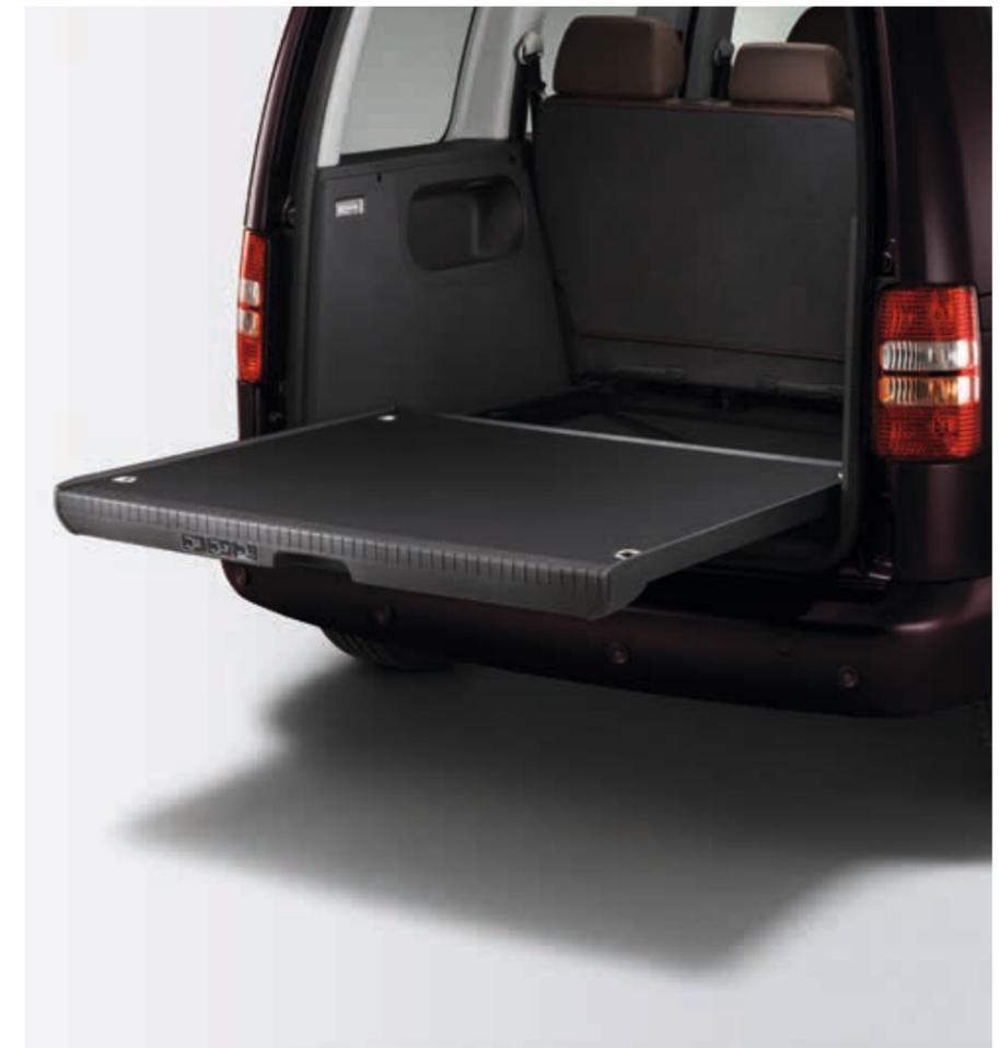
**Le plancher de chargement coulissant.** Il coulisse en deux temps et facilite le chargement et le déchargement des charges lourdes. La capacité de charge maximale sur le plancher lorsqu'il est déployé est de 80 kg.
