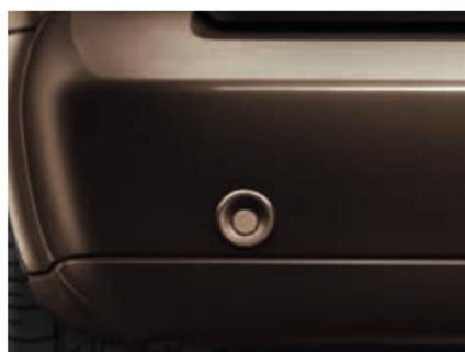
**Les capteurs d'aide au stationnement.** Quatre capteurs situés dans le pare-chocs arrière et un signal sonore apportent une aide précieuse quand il s'agit de se garer.
