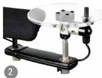
2 - Commande proportionnelle manuelle MicroPilot : joystick isométrique, force de poussée 10 à 50 gr, débattement 0°. Commande fixée sur plateau appui-palme.
