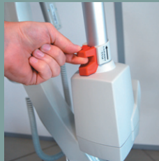
Descente de secours
