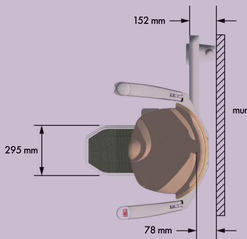
Toutes les dimensions mesurées à partir du mur sont données à titre indicatif. La présence d'une plinthe plus large ou de tout autre élément similaire peut modifier les mesures prises à partir de ce point. Les mesures sont données en millimètres.
