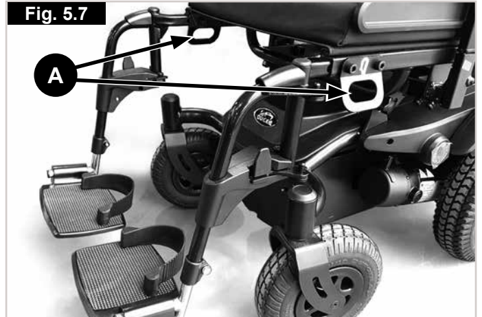
Positionnement du système d'arrimage avant, (Fig. 5.7 - A).
