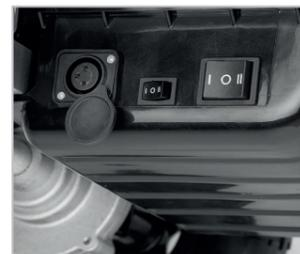
Chargement batterie et interrupteurs pliage / dépliage.
