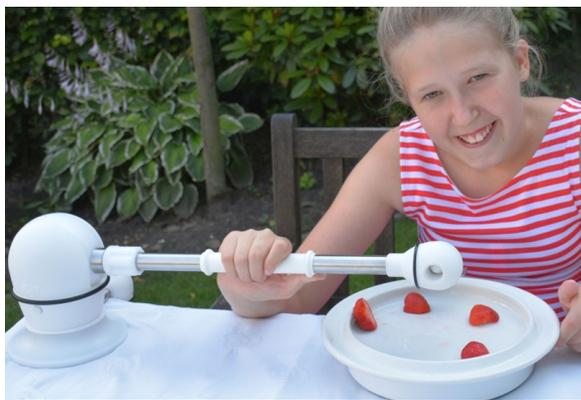
L'iEAT est l'un des dispositifs d'alimentation dans notre assortiment. L'iEAT est disponible en différents modèles, il prend en charge l'utilisateur lors des repas en coordonnant les mouvements nécessaires. Pour les personnes qui souffrent de spasmes ou tremblements, il fonctionne en annulant des mouvements incontrôlés au moyen d'un mécanisme d'amortissement. L'appareil offre une résistance qui permet à l'utilisateur d'effectuer des mouvements contrôlés lors de la consommation.
