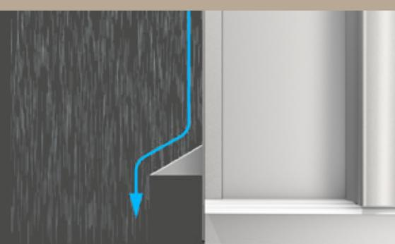
**PLAQUE D'ÉGOUTTEMENT** – Placée à la base de la gaine, la plaque d'égouttement déporte les écoulements loin de la gaine.
