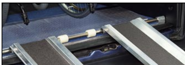
Prévoir un faux plancher de 40 mm. En l'absence de faux plancher il est possible de commander un profilé qui permet de rattraper l'épaisseur.
