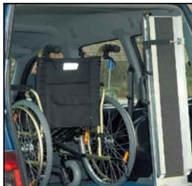
Pendant le transport, les rampes sont maintenues à la verticale sur les côtés grâce aux sandows de blocage.
