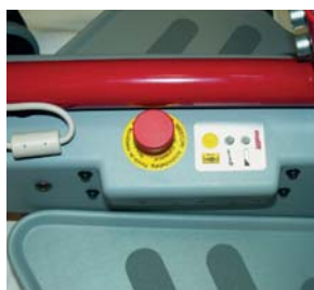
Système électronique équipé de l'arrêt d'urgence et indicateurs d'alarme
