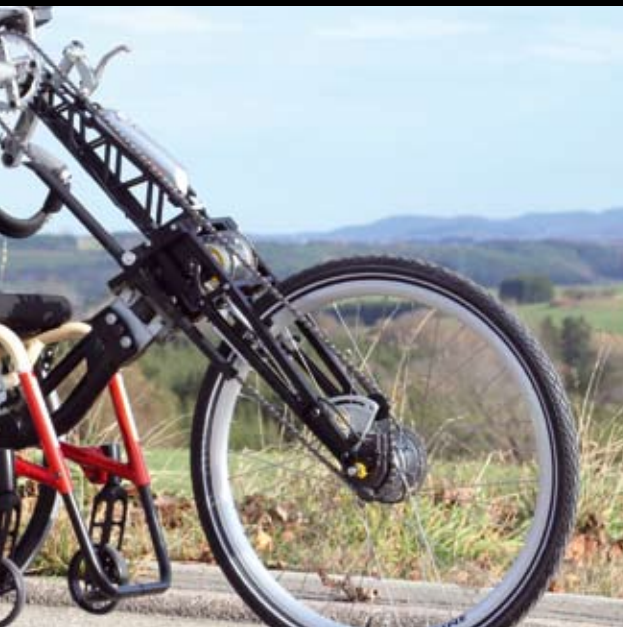
L'ensemble propulsif avec le Cyber Nexus à 8 vitesses automatiques permet l'adaptation électronique de la démultiplication de force pendant le parcours.
